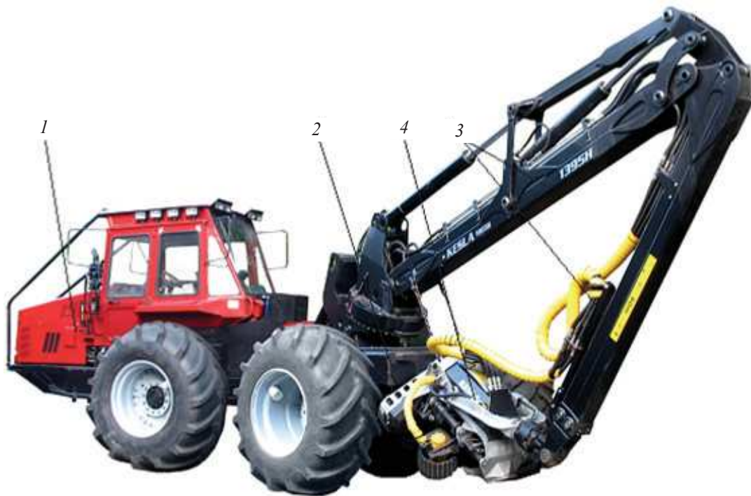
Рис. 5. Общий вид харвестера МЛХ-414: 1 – энергетический модуль; 2 – технологический модуль; 3 – манипулятор; 4 – харвестерная головка
