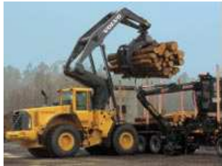
Рис. 1. Фронтальные лесопогрузчики зарубежного производства a – Caterpillar 966 G II; б – Volvo L180E HL
