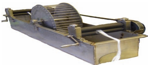
Рис. 4. Стеновая установка для непрерывной промывки жгутового волокна
