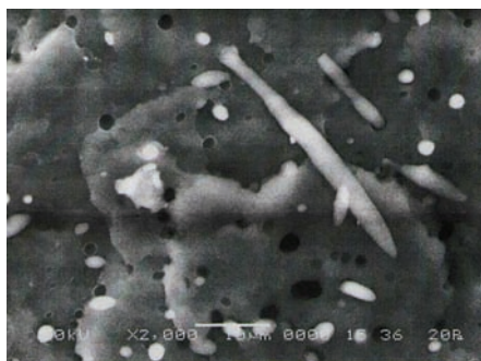
Рис. 4. Структура образца при вытяжке (композиция ПП + 10% КФМ). Увеличение \times 2000
