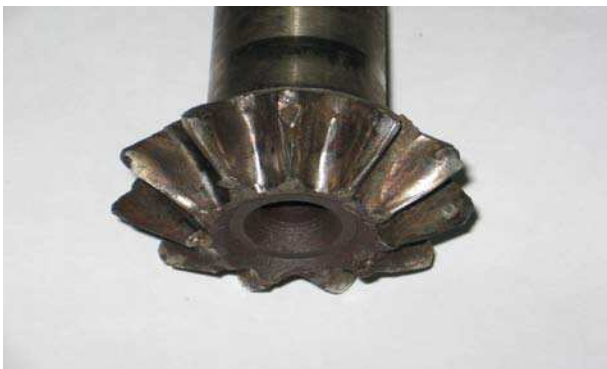
Рис. 4. Изношенные зубья вала-шестерни редуктора переднего ведущего моста ТТР-401
