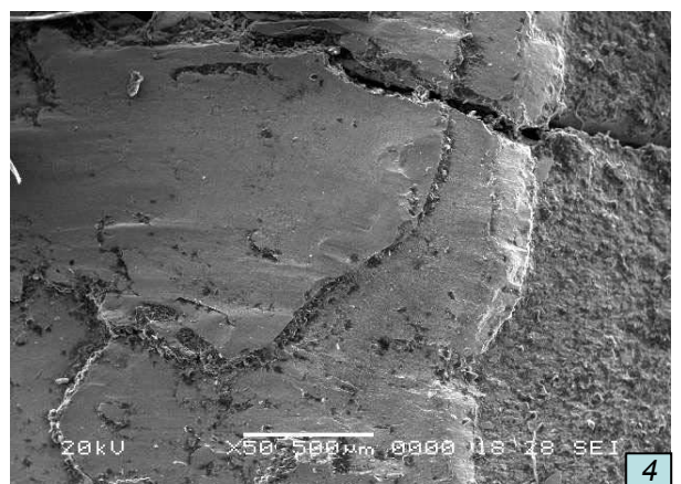
Рис. 5. Поверхность износа зубьев при наработке: 1 – 150; 2 – 400; 3 – 850; 4 – 1200 моточасов
