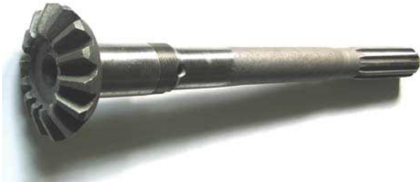
Рис. 3. Полуось конического редуктора переднего ведущего моста трелевочного трактора
