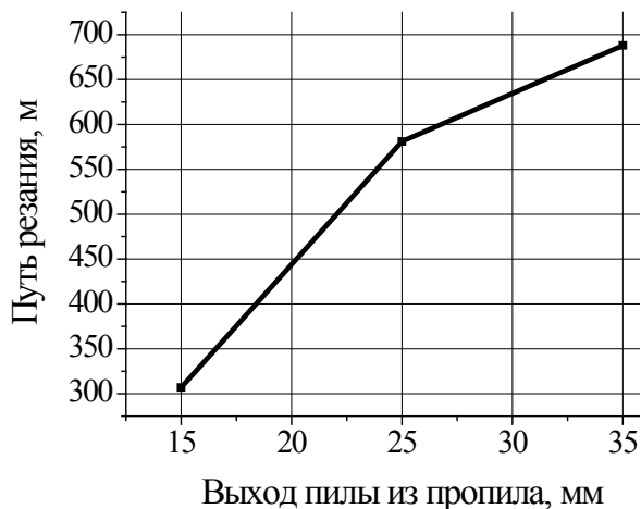
Рис. 4. Зависимость пути резания от выхода пилы из пропи́ла при U_z = 0,04 мм
