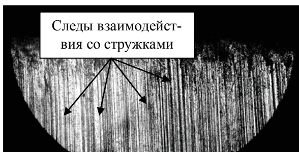
Рис. 3. Износ передней поверхности резца концевой фрезы при обработке ДСтП
