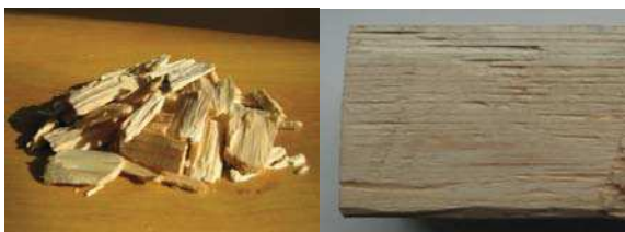
Рис. 10. Качество технологической щепы и пласти бруса при X_1 = +30^\circ , X_2 = +20^\circ , X_3 = 0 мм
