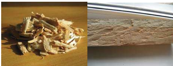
Рис. 9. Качество технологической щепы и пласти бруса при X_1 = 0^\circ , X_2 = 0^\circ , X_3 = 0 мм
