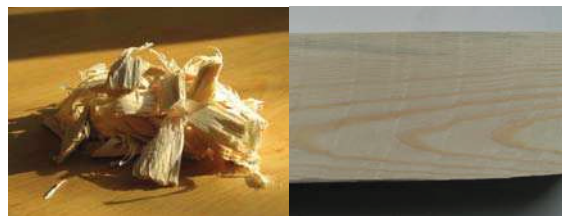
Рис. 11. Качество технологической щепы и пласти бруса при X_1 = +15^\circ , X_2 = +20^\circ , X_3 = -2,5 мм
