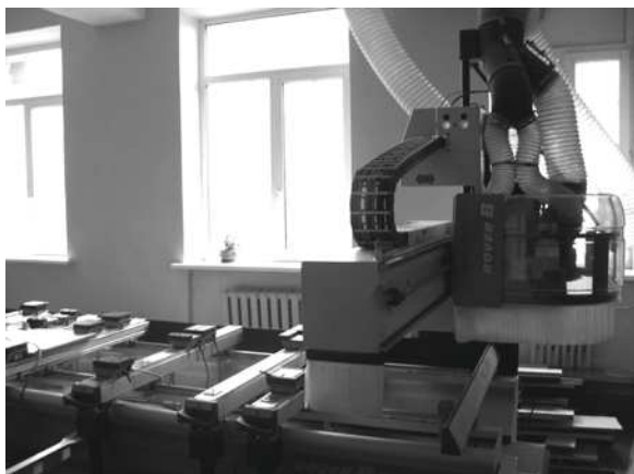
Рис. 1. Деревообрабатывающий центр с ЧПУ ROVER B 4.35
