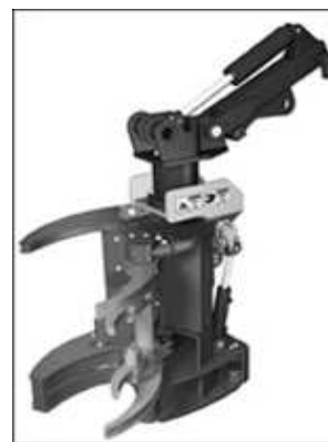
Рис. 1. Технологическая головка с ножами силового резания и накопителем деревьев
