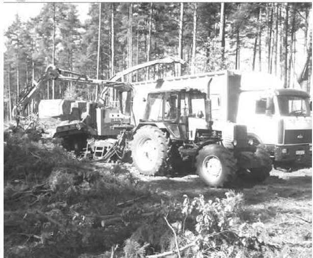
Рис. 4. Измельчение голья системой машин «МТЗ-1221+МР-40 – МАЗ-551608-245Р»
