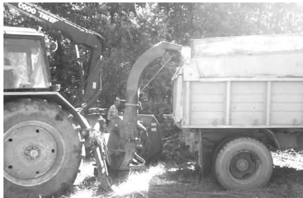
Рис. 5. Измельчение голья системой машин «МТЗ-1221+СН 260 НФ – ЗИЛ-130»
