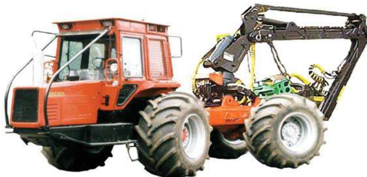
Рис. 1. Общий вид харвестерной машины с шарнирно-сочлененной рамой для рубок промежуточного пользования на базе лесного шасси с колесной формулой 4К4
