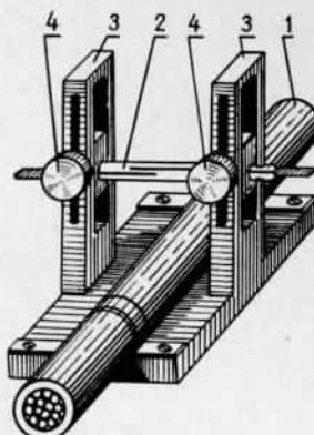
и состоит из геркона 2, перемещающегося, с целью установки на определенный ток срабатывания, по направляющим 3, и фиксаторов 4. Все детали устройства выполнены из немагнитного материала, а само устройство при необходимости защиты от влияния посторонних электромагнитных полей, закрывается ферромагнитным корпусом.
