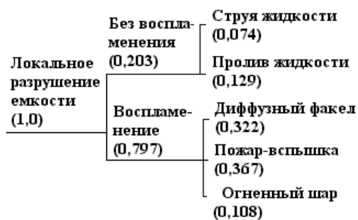
Рисунок. «Дерево событий» локального разрушения емкости с ЛВЖ и ГЖ на АЗС
