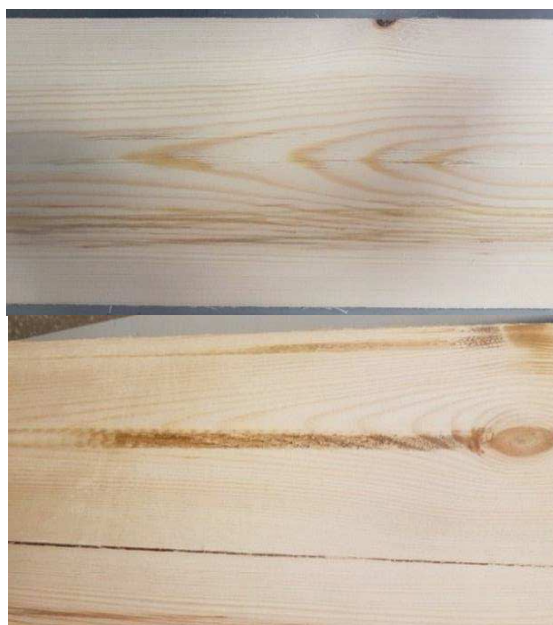
Рис. 4. Дефекты на поверхности шлифования в виде прижегов
