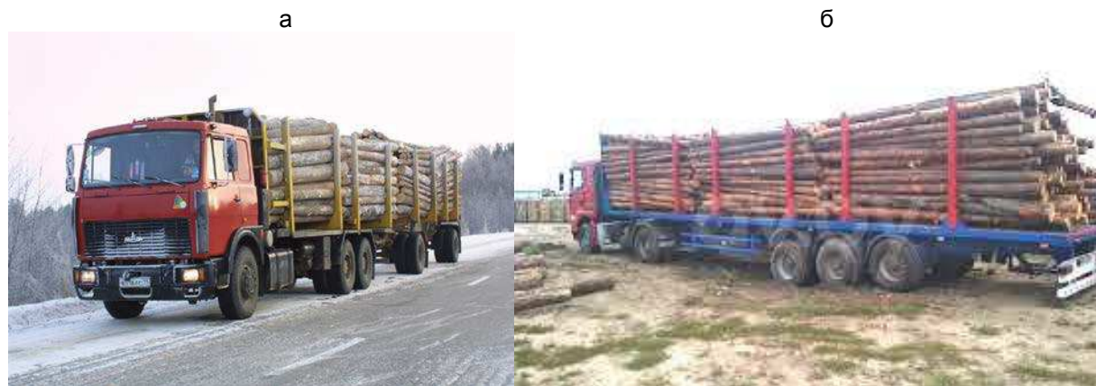
Рисунок 1 – Общий вид автопоездов-сортиментовозов: 1 – с прицепом; 2 – с полуприцепом
