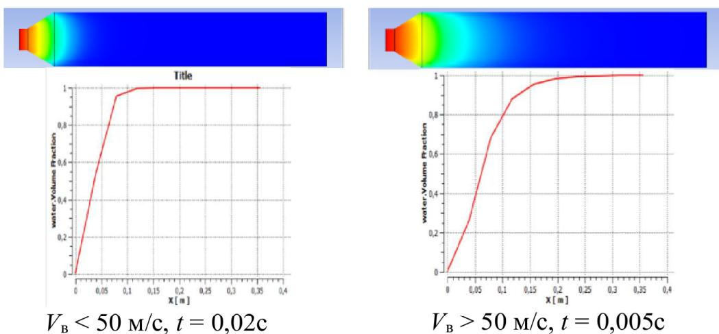
Рис. 2. График изменения соотношения воздух-вода в газо-жидкостном потоке при скоростях подачи распыливающего сжатого газа до и выше 50 м/с
