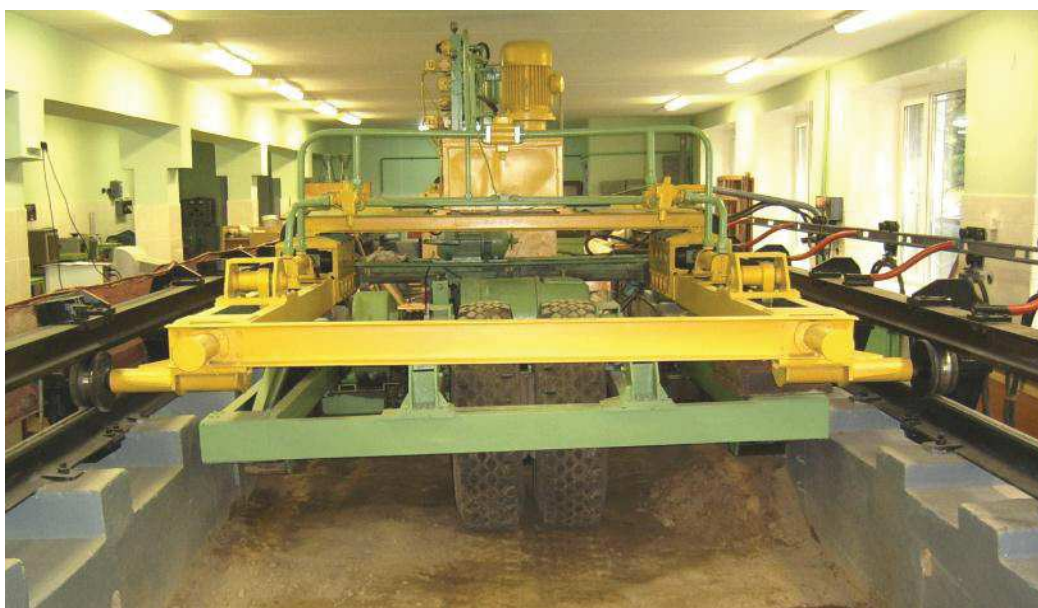
Рисунок 2 – Общий вид экспериментального стенда БГТУ для испытания дорожных конструкций
