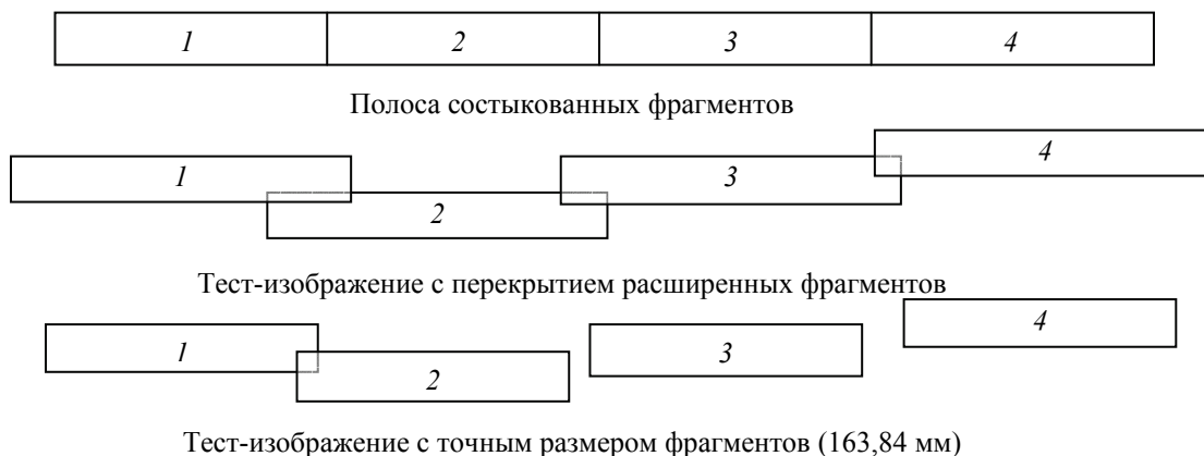
Рис. 6. Тест-изображения при контроле взаимного положения МЭС вдоль X-координаты
