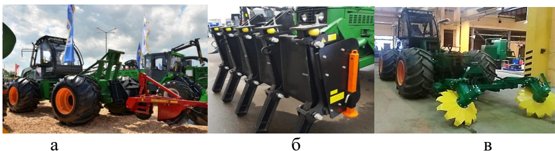
Рис. 4 - Быстросъемные рабочие органы для проведения лесохозяйственных работ: а – плуг лесной ПКЛ-70, б – грабли лесные, в – фреза почвообрабатывающая активная
