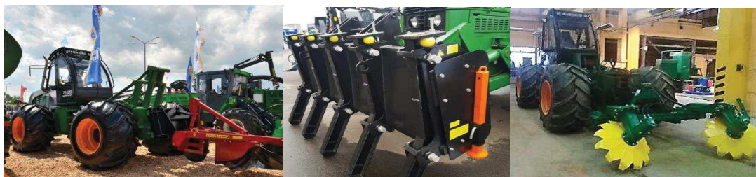
Рис. 4 - Быстросъемные рабочие органы для проведения лесохозяйственных работ: а – плуг лесной ПКЛ-70, б – грабли лесные, в – фреза почвообрабатывающая активная
