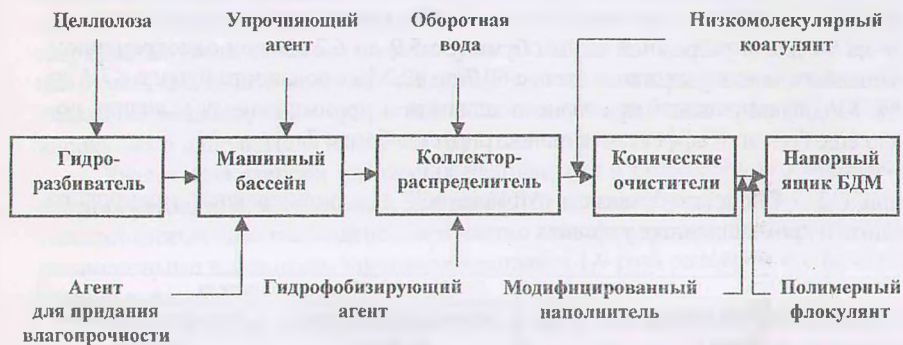
Рисунок 6 - Блок-схема использования химических вспомогательных веществ и модифицированных карбонатных наполнителей
