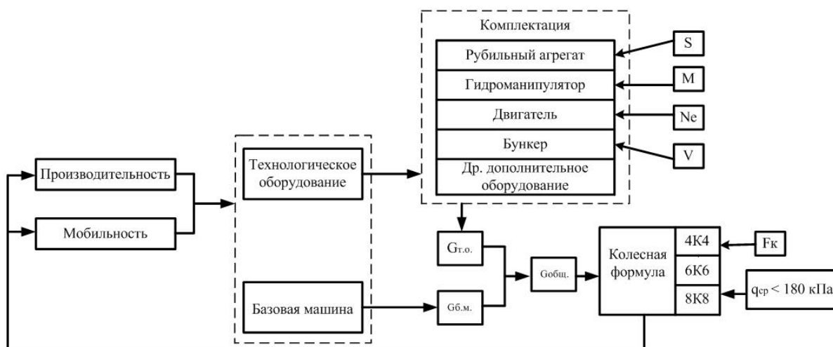
Рис. 3. Схема обоснования параметров технологического оборудования и базового шасси самоходной рубильной машины
