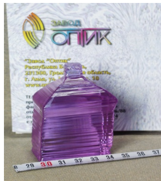
Рис. 1. Монокристалл \text{KGd}(\text{WO}_4)_2: \text{Nd} , выращиваемый на ОАО «Завод «Оптик»», г. Лида
