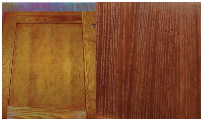
а – до нагрева поверхности древесины (с дефектом «яблочность»); б – после нагрева поверхности древесины до 30°С
