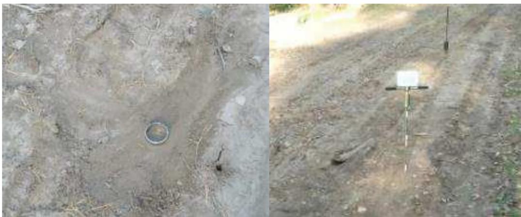
**Рисунок 1 – Взятие пробы режущим кольцом и определение прочностных характеристик пенетрометром ПГ-3М**
