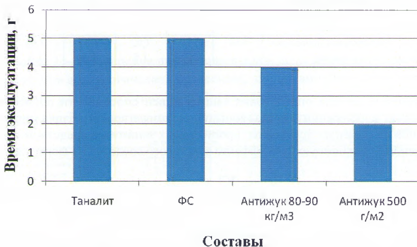
Рисунок 1. Продолжительность сохранения защитных свойств археологической древесины по отношению к дереворазрушающим грибам при поглощении 80-90 кг/м 3 защитных средств после циклических испытаний
