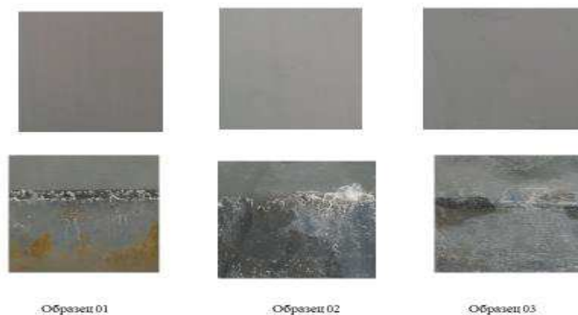
Фотографии образцов до проведения испытаний (верхний ряд). Фотографии образцов после выдержки в 3% растворе раствора 6 суток
