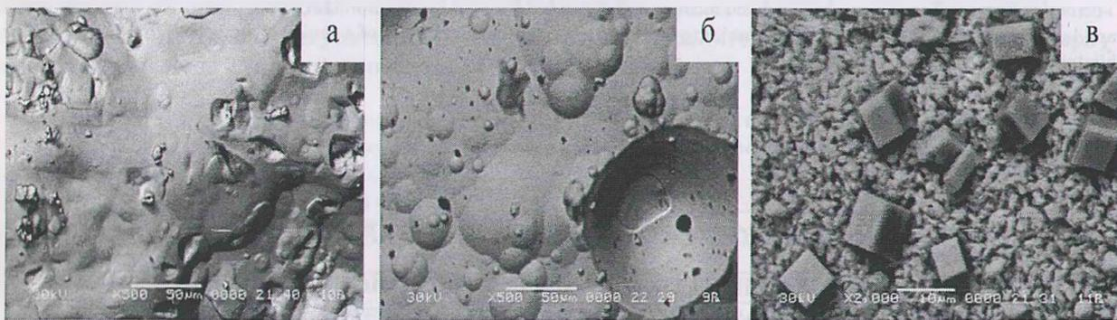
Рис. 1. Микрофотографии образцов, полученных при  $i = 1 \text{ А/дм}^2$ , при увеличении в  $500$  (а, б) и  $1000$  (в) раз: а –  $\text{PbO}_2/\text{SnO}_2$ ; б, в –  $\text{Co-PbO}_2/\text{SnO}_2$
