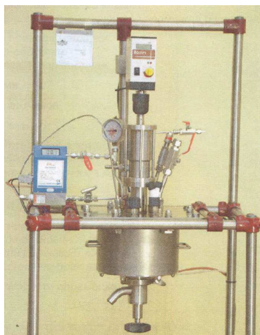
Рисунок 1 – а) Схема лабораторной установки для синтеза алкидно-стирольных смол; б) Стальной реактор ROOM
