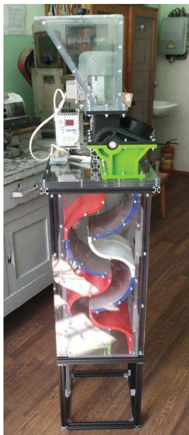
а) – принципиальная схема; б) – внешний вид экспериментальной установки; 1 – фильтровальный элемент, 2 – металлический корпус, 3 – патрубок с питателем для подачи влажного материала, 4 – ячеяковый питатель 5 – вентилятор, 6 – шибер, 7 – патрубок для отвода фильтрата, 8 – патрубок отвода обезвоженного материала, 9 – емкость для сбора обезвоженного материала
