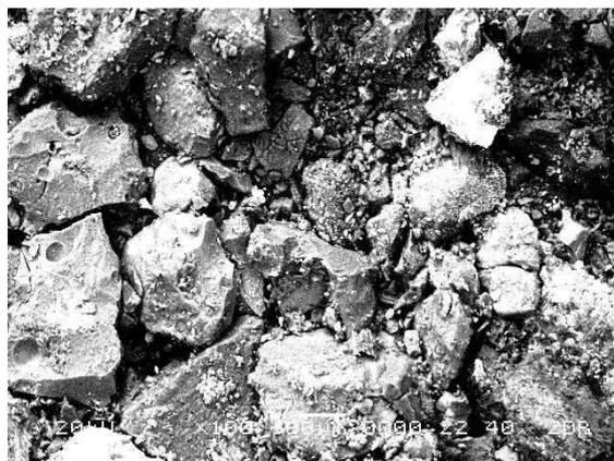
**Рисунок 1 – Электронно-микроскопический снимок поверхности продукта пиролиза резинотехнических изделий**
