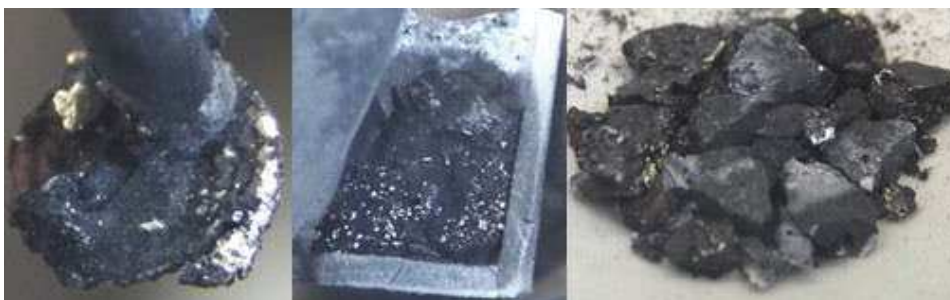
Рисунок 3 – Фотографии продукта восстановления \text{ZrO}_2 в ходе после электролиза расплава \text{LiCl-KCl-Li}_2\text{O}
