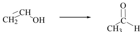
Рис. 3.3. Реакция изомеризации винилового спирта в уксусный альдегид
