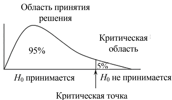
Схема принятия решения о нулевой гипотезе с помощью критериев согласия
