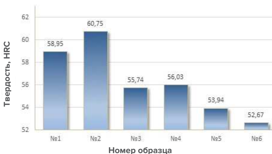
Рис. 8. Средняя твердость композиционных плазменных покрытий при содержании TiO_2 в смеси порошков для напыления: №1 – 33 %, №2 – 25 %, №3 – 20 %, №4 – 15 %, №5 – сплав ПГ-ХН80СР4 без добавок, №6 – сплав ПС-12НВК-01
