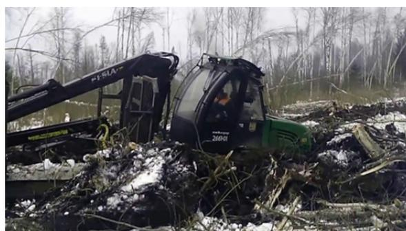
Рис. 1. Низкая несущая способность лесных почвогрунтов при выполнении подвозки лесоматериалов
