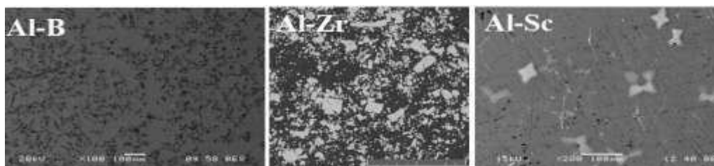
Рисунок 3 – Микрофотографии лигатур алюминия с бором, цирконием и скандием, полученных при электролизе расплавов \text{KF-NaF-AlF}_3\text{-Al}_2\text{O}_3 с добавками оксидов \text{Sc}_2\text{O}_3 , \text{ZrO}_2 и \text{B}_2\text{O}_3 при 800^\circ\text{C}
