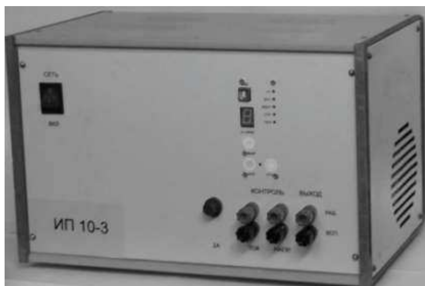
Рисунок 1. – Программно аппаратный технологический комплекс синтезирующий импульсы стабильного тока произвольной формы для процессов нестационарного электролиза
