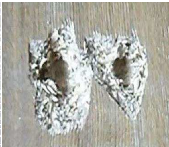
Рисунок 2 – Дефекты обработки в виде сколов на выходе сверла из отверстия
