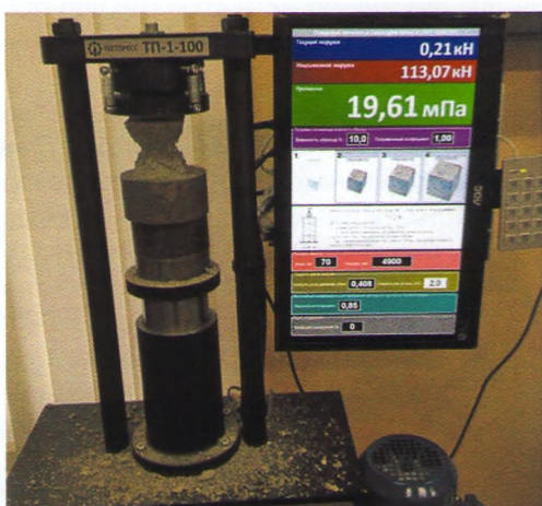
Рис. 3. Тестпресс ТП-1-100 для испытания кубиков из бетонокомпозитных цементно-песчаных смесей
