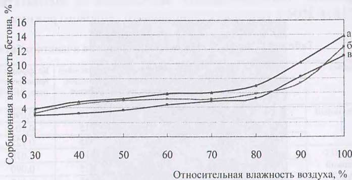
Рис. 5. Зависимость сорбционной влажности бетона от относительной влажности воздуха: а – контрольный образец; б – образец с добавкой САФД; в – образец со шлаком и добавкой САФД
