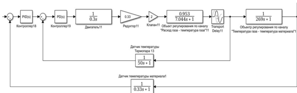
Рис. Структурная схема каскадной схемы управления сушилкой
