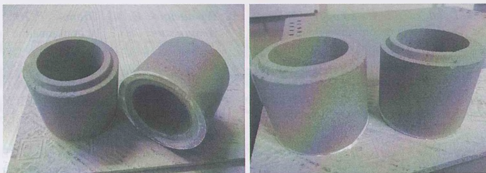
Рис. 7. Внешний вид термостойких кордиеритсодержащих изделий, полученных с использованием 2-го слоя глины месторождения «Крупейский сад» ( T_{\text{обж}} = 1300\text{ }^{\circ}\text{C} )
