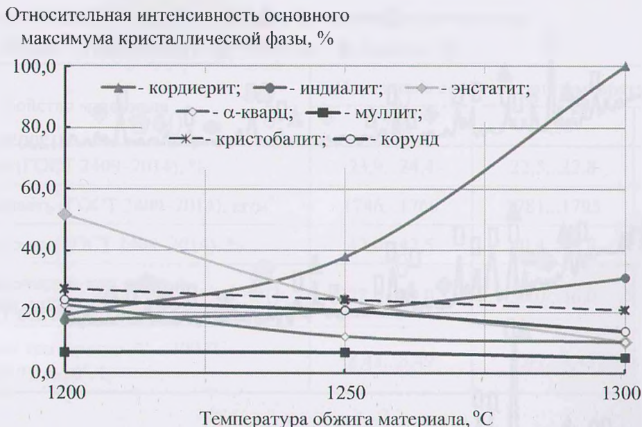
Рис. 5. Зависимость интенсивности дифракционных максимумов кристаллических фаз в кордиеритсодержащем материале от температуры обжига
