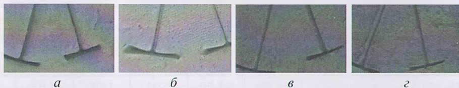
Рис. 1. Внешний вид образцов, полученных на основе 1-го (а), 2-го (б), 3-го (в) и 4-го (г) слоев глины месторождения «Крупейский сад» при температуре обжига 1000 °С
