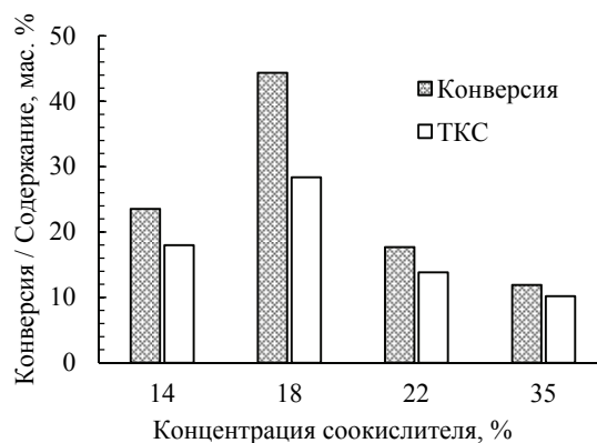
Рис. 1. Диаграмма зависимости конверсии \alpha -пинена и содержания ТКС от концентрации растворов соокислителя \text{H}_2\text{O}_2
