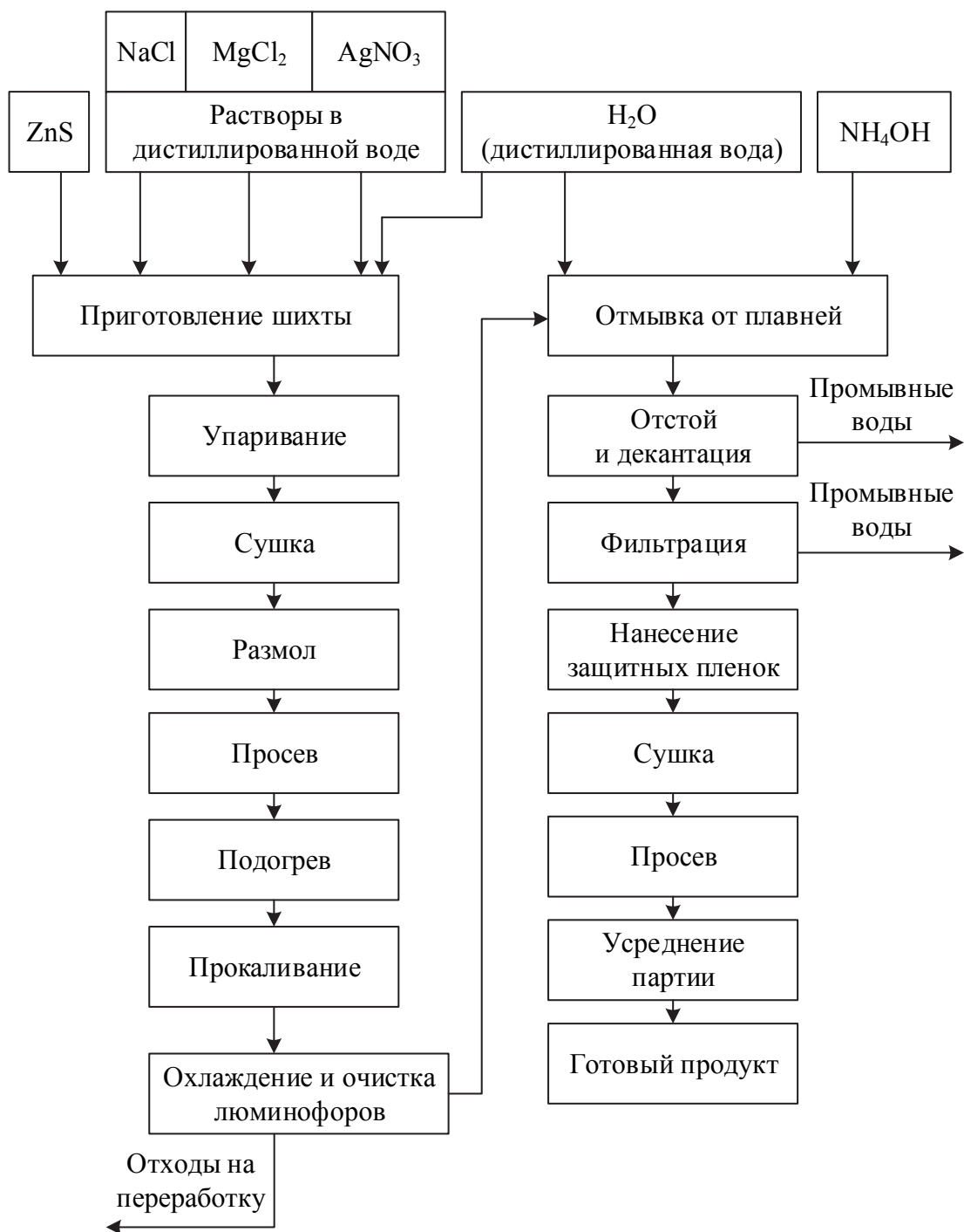
Рис. 4.2. Принципиальная технологическая схема получения сульфида цинка, активированного серебром ZnS : Ag
