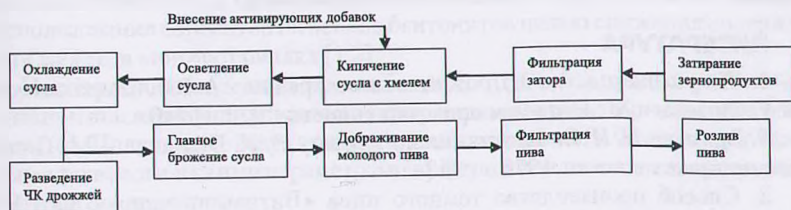
Рис. 2. Структурная схема процесса производства пива с применением активирующих добавок на стадии приготовления пивного сусла
