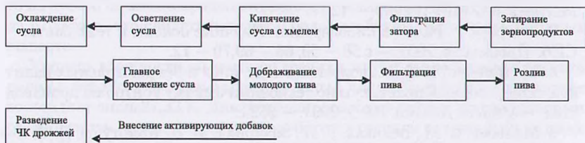
Рис. 1. Структурная схема процесса производства пива, с применением активирующих добавок на этапе культивирования дрожжей
