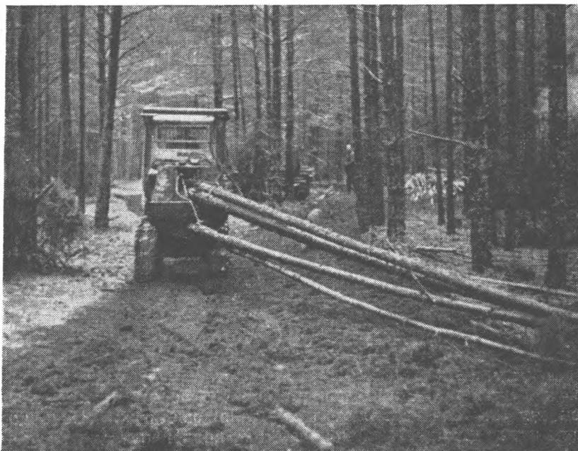
Рис. 3. Трелевка древесины трактором Т-54Л на рубках ухода за лесом.
