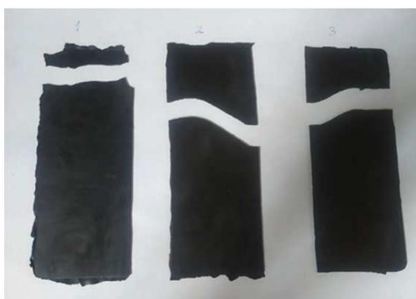
Рисунок 1 – Разрыв эластомеров, облученных рентгеновским излучением с различной мощностью экспозиционной дозы рентгеновского излучения:
