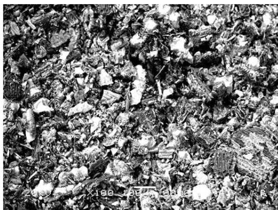
Рисунок 1 – SEM-изображение КРШ при увеличении ×100
